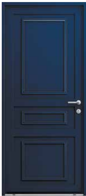
EXTÉRIEUR ALUMINIUM Couleur bleu 5003 T. Moulures rapportées. INTÉRIEUR BOIS Finition chêne champagne. Ud \geq 1,4 \text{ W/m}^2.K
